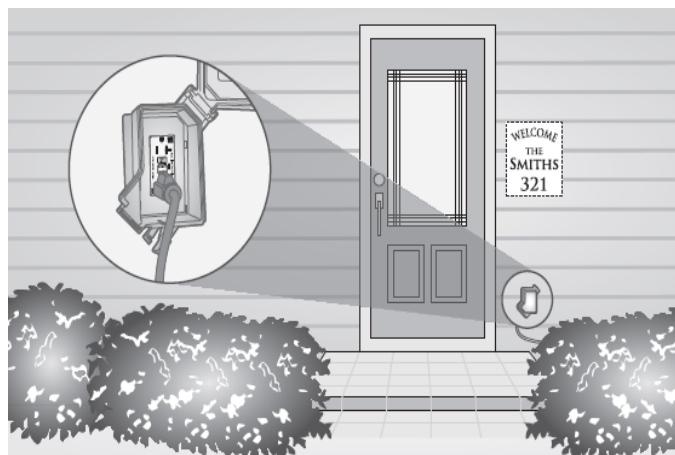
Figura 3. De acuerdo con el NEC 2014, todos los tomacorrientes que se instalen en lugares exteriores que puedan mojarse deben tener protección para intemperie y protección GFCI.
