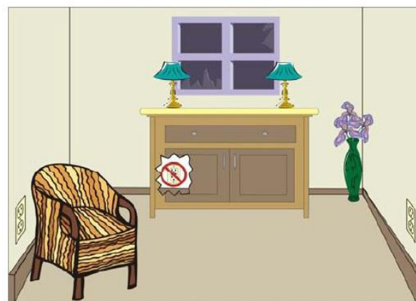
Figura 3. Tomacorriente GFCI ubicado detrás de un mueble fijo. Esto es una violación al Código Eléctrico ya que limita el fácil acceso al dispositivo en caso de que se necesite restablecerlo. [3]
