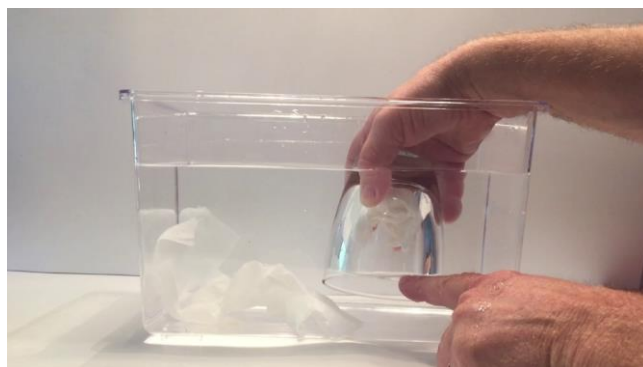
Figura 3. Experimento en casa para comprobar el principio de la campana de buceo.
